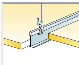
Système de suspension : clip + suspente réglable.
