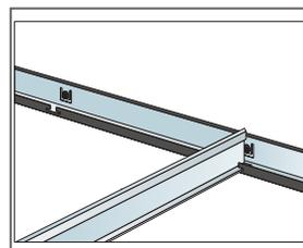
Korridorprofil, positioniert durch den modularen Wandwinkel
