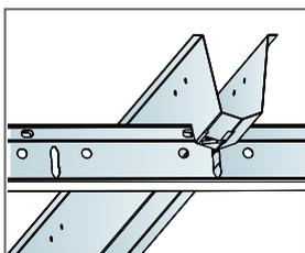
Conexão entre perfis com gancho Space bar
