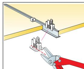
Kürzen des Connect Hygiene-Clips 20 bei revidierbarer Platte
