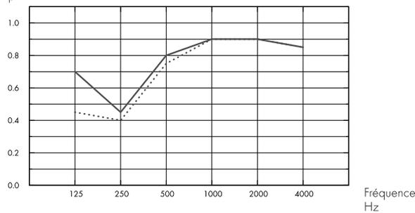
..... Performance Baffle orientés en rangées entraxe 600 mm avec 1,4 baffles/m<sup>2</sup> de surface de plafond, hht: 600 mm
